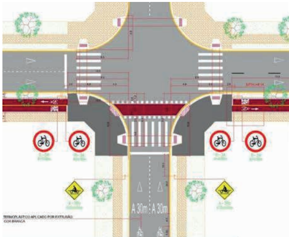
Segregadores até o limite da curvatura de retorno para proteção, e sinalização vertical e horizontal específica.
